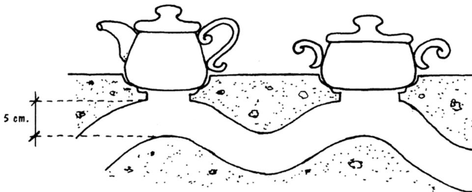
La parte superior del extremo del túnel, donde se junta con el agujero de la chimenea, deberá quedar a unos 20cm. de la superficie de la estufa.
